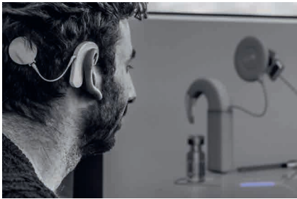
Träger eines klassischen Cochlea-Implantats vor einem optischen Cochlea-Implantat mit optischer Faser (blau). Foto: F. el May, M. Zerche, umg/MBExC.
